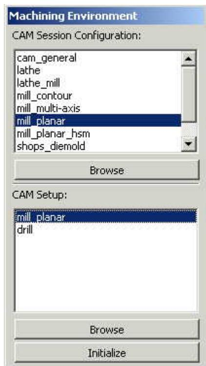
A continuación aparecerá una ventana en donde tendremos que especificar el tipo de operación a realizar. Se elige el tercer ícono de la primera fila (planar mill). Este es la operación que utilizaremos para la fabricación de nuestra pieza.
