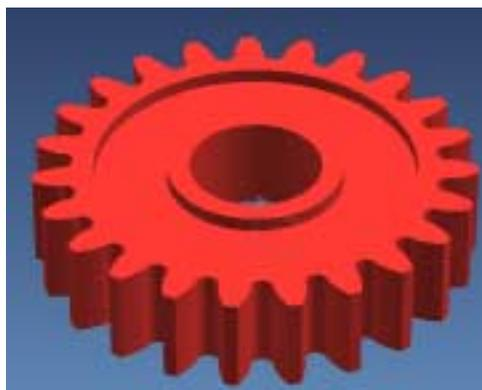
Fig. 5. Creación de un ligero vaciado, por ambas caras de un engrane
