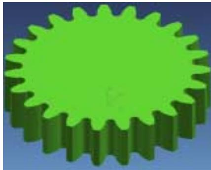
Fig. 3. Extrusión de un perfil.
