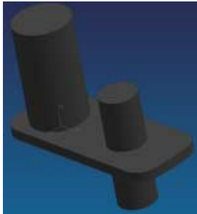
Fig. 1 Modelo Propuesto: Creación de un conector del engrane con la biela.
