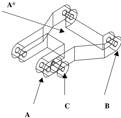
Ahora se aplicará un nuevo Sketch Plane en el plano A\* que se indica arriba y se pondrá la vista superior para dibujar con polilínea el trapecio que se muestra en la figura, después que se haya dibujado se le dará una categoría de un perfil al trapecio dibujado con Part>Sketch>Profile y a continuación se aplicarán las siguientes restricciones.
