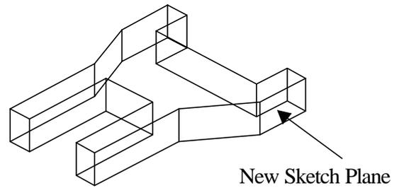
Se mostrará la vista del isométrico ( 7 ) que se muestra en la figura, se asigna un nuevo Sketch Plane en la cara que se indica en la figura anterior para posteriormente generar una envolvente a la vista con las siguientes restricciones:
