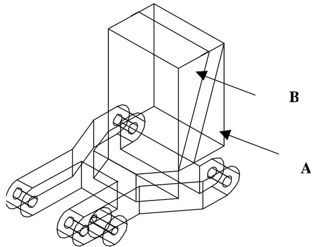
Con un New Sketch Plane se selecciona el plano y se dibujan dos triángulos, que después se procederá cortar cada uno. Primero se dibujaran con polilínea y se les aplicará un perfil a cada uno y después se procede a cortar con:
