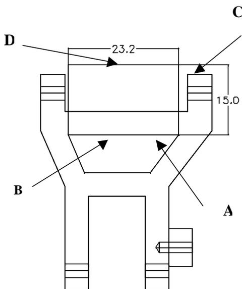
Ahora se le aplica un New Sketch Plane en el plano A\*\* como se muestra en la figura anterior para dibujar el rectángulo pero antes hay tener una vista superior, y se hará con una polilínea con esas medidas y se restringirá como se indica:
